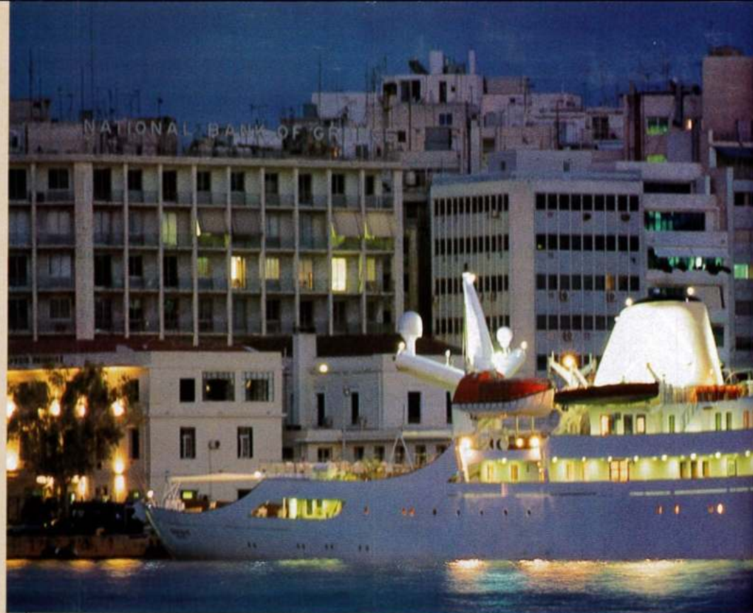
ΤΑΥΤΟΤΗΤΑ: Όνομα CHRISTINA O. Ναυπήγηση: Καναδάς, Έτος: 1943. Προηγούμενο όνομα: HMCS STORMONT. Μετασκευή: 1954 και 2000/1. Μήκος: 99,14 μέτρα. Πλάτος: 11,15 μέτρα. Βύθισμα: 4,26 μέτρα. Συίτες: 18 + πλοιοκτήτη. Επιβάτες: 36. Μηχανές: Δύο MAN (2.040 kWx2).
